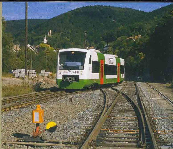
Rückfallweichen ausgerüstet, erkenntlich an den gelben Weichenlaterne (Bild). Damit wird erreicht, dass die Weichen nicht bedient werden müssen. Somit muss auch kein Personal auf diesen Bahnhöfen eingesetzt werden. Die Bahnübergänge wurden auf den technisch neuesten Stand gebracht. Sie werden überwiegend vom Zug selbst über Gleiskontakte aktiviert, zwei Schranken werden vom Triebfahrzeugführer mittels Infrarot-Strahler bedient.
